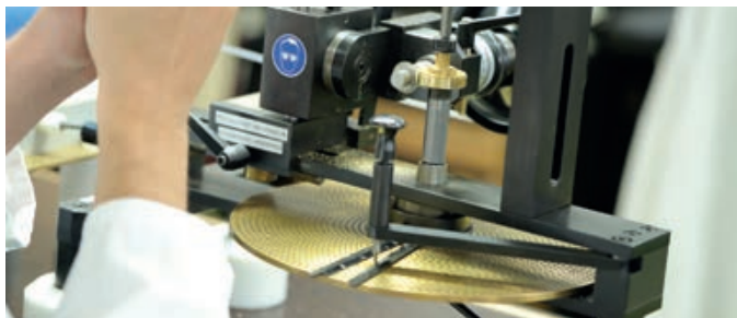
ムーブメントの歯車を作るための歯車切削機。
