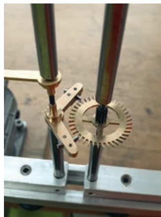
グラハムエスケープメントは、輪列が尚早かつ制御されずに動作することを防ぎます。
