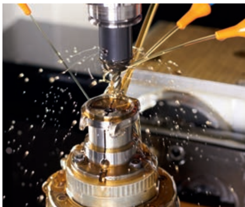
SUGの自動加工機でほぼ完成されたミドルケース。
