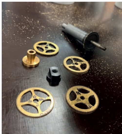
ムーブメント内で動力を伝達する歯車。研修生自らが製作。
