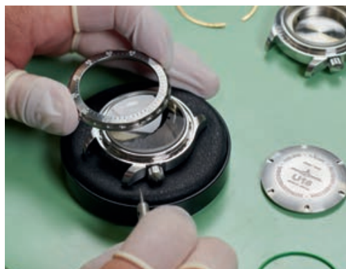
最終組立では、各部品から、完成したケースが組み立てられます。
