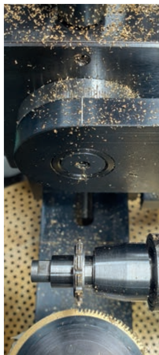
モジュール旋盤を使用して、ホイール状のブランク材で歯車の歯を製作。
