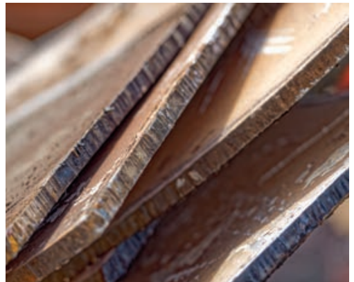
ドイツの非磁性潜水艦鋼の平板。後続の加工のためにはまずは真っすぐにする必要があります。
