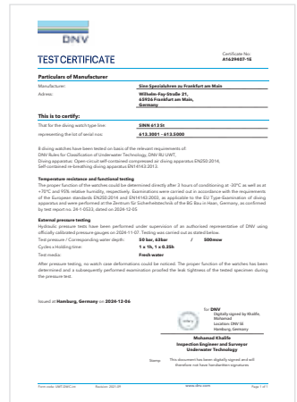
シリーズ 613 Stでは、水深500mまでの耐圧性、並びに欧州潜水器具規格EN250とEN14143に準拠した温度耐性および機能がDNVにより認証されています。
