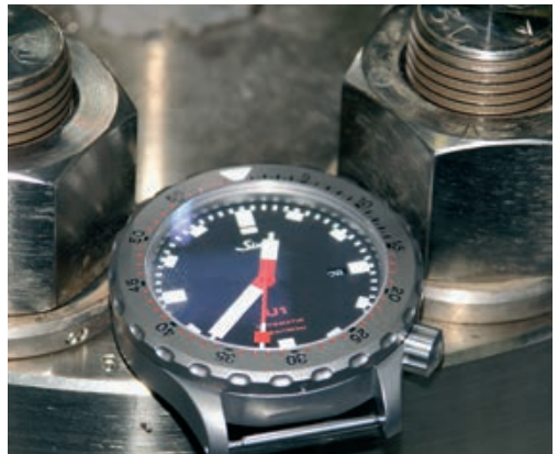
36mmネジ接合の圧力槽:100気圧のテストを楽々通過したU1。 1気圧 = 100,000パスカル。
