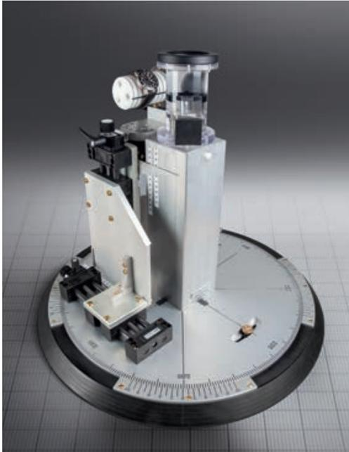
DIN 8330準拠のパイロットウォッチでは、航空機内で認可されている磁気コンパスを近づけることにより、その磁気特性が明らかに逸脱することがあってはいけません。特別試験台を用いて、パイロットウォッチの磁気特性を特定します。磁気特性とは、そこにある磁界を、物体固有の方法で変化させたり、これに影響を与えたりする特徴のことです。飛行機のコックピットで腕時計を使用すると、その磁気特性が飛行機の非常用コンパスを狂わせてしまうおそれがあります。その可能性を排除するため、テスト用の時計（ここでは**103 TI IFR**）を消磁し、その後、定義した磁界強度が均等に広がる磁場に晒します。試験の第2段階では、写真の試験装置を用いて、テスト用時計の磁気特性を評価します。さらに信頼性を向上させるためには、例えばチタンのようにできる限り非磁性の材質をケースに使用するという方法があります。このようなコンセプトで設計されたミッションタイマーは、それ自体が磁界を干渉することもなく、同時に、DIN 8309で定められている耐磁時計に関する基準を満たすこともできます。
