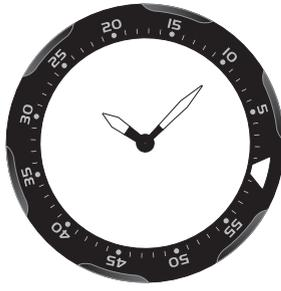
外側に配置されたベゼルは、カウントダウンベゼルとして作られています。これを使うことで、例えば、救急ヘリコプターのローターが回転し始めるまでに残っている時間を追跡し、あるいは医薬品の効果が発生するまでの時間を監視することができます。そのために、残りの時間間隔(例えば10分)を分針上に回します。分針が三角マーキングに到着したら、予め設定した時間間隔を過ぎたということです。
