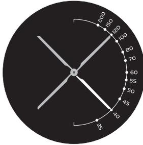
パルスローターは、脈拍を迅速に把握するのに役立ちます。それには、目盛りの開始位置(12時)にセットされた4つのローター羽の一つが到着するまで待ちます。脈が15回打つのを数えて、15回目の脈でパルスローター目盛り上の1分間の脈拍数を読みます。白く塗られたローターブレードは、通常の三針ウォッチの秒針に相当しますが、それに加えて秒針ストップ機能により時計を秒単位でぴったりと設定するのに役立ちます。
