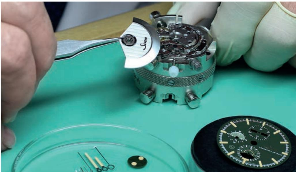
3006に内蔵された繊細な加工が施されたムーブメントは、巻上げローターの組込みによって完璧を極めています。フィリグランが施された針、文字盤、そしてムーンディスクが、取付けを待っています。
