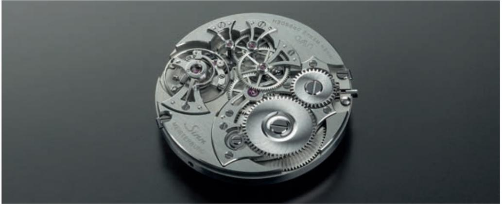
精巧に加工された自社製手巻きキャリバーUWD 33.1は、55時間のパワーリザーブを備えています。テンプ機構の釣合いを精確に保つためにてん輪に施された6つの偏心ネジが、よく見て取れます。その調速機構はスワンネックの機能原則に従って、ムーブメントを正確に微調整します。
