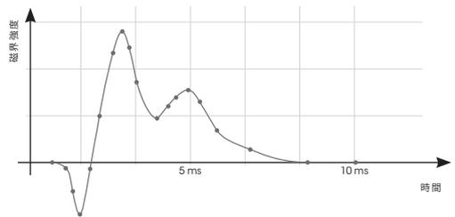
クォーツ時計の針が一秒を刻むとき、それによって電磁インパルスの放射が避けられません。モーターコイルを制御電流が流れ始め、モーターが引き起こす回転運動が、誘導電流をもたらします。図には、ステッピングプロセスの典型的「心拍曲線」に対して、電磁的成分だけが表現されています。
